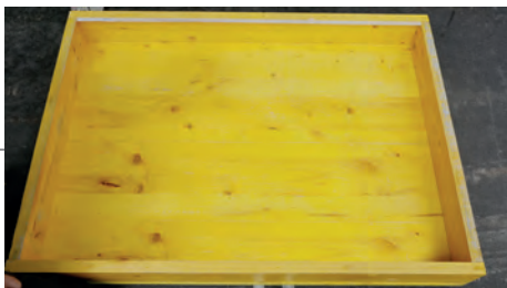
Ausschalen Bei der Verputz-Variante das Einlegeholz entfernen
